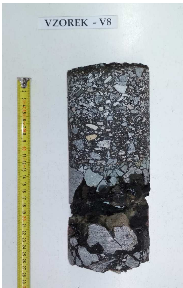
Obr. 16- Jádro vývrtu Vzorek – V8 (laboratoř).
