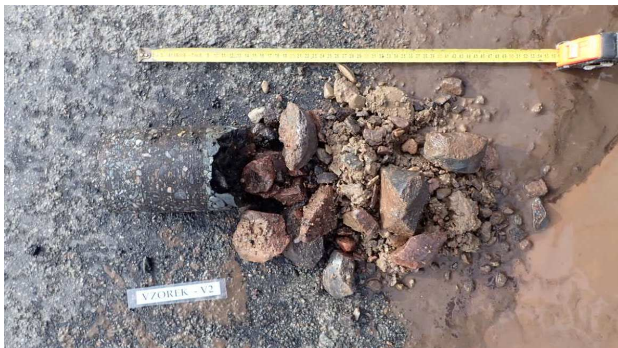
Obr. 3 - Jádro vývrtu Vzorek – V2 (in situ).
