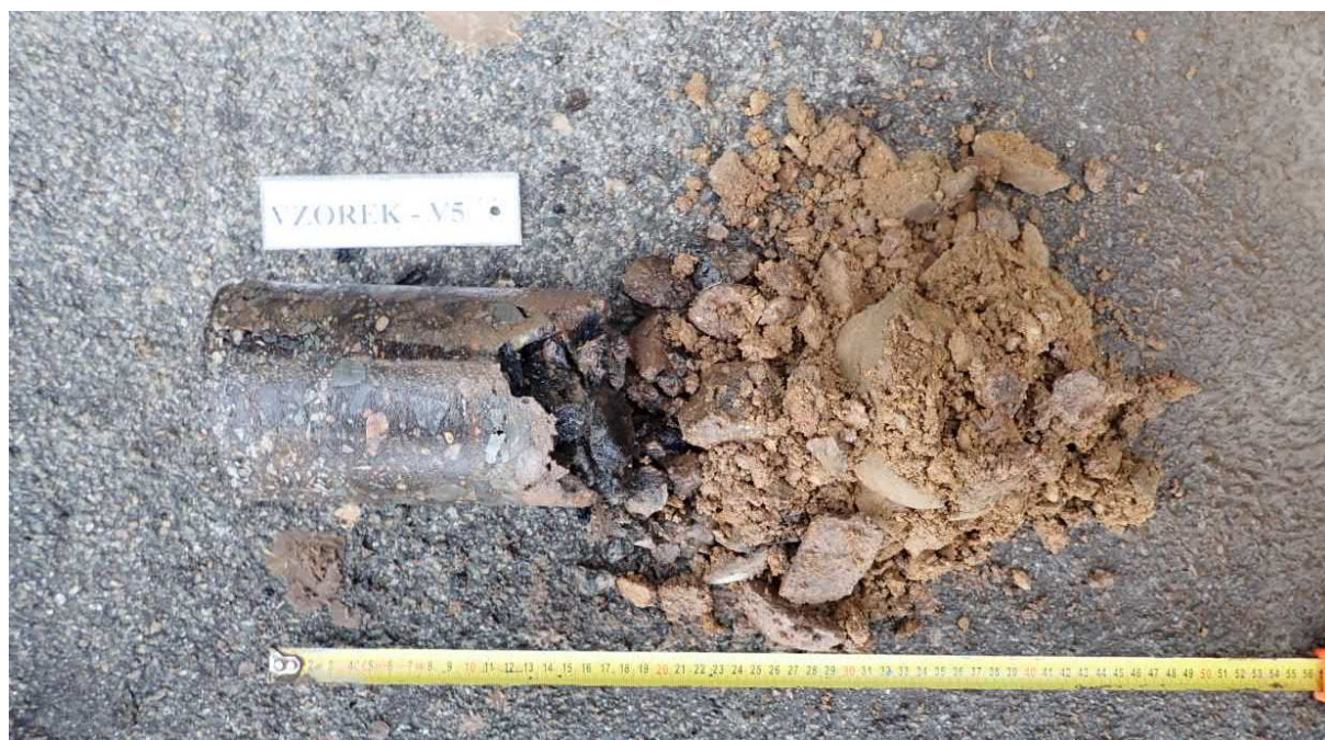
Obr. 9 - Jádro vývrtu Vzorek – V5 (in situ).
