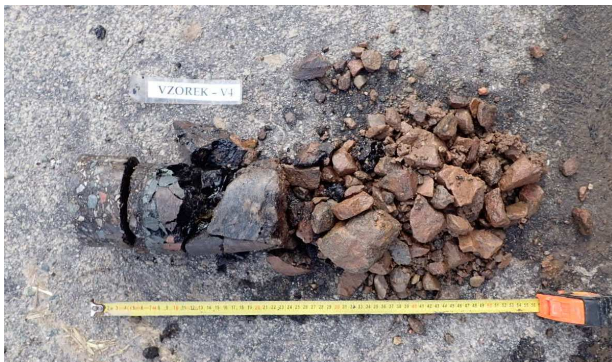
Obr. 7 - Jádro vývrtu Vzorek – V4 (in situ).
