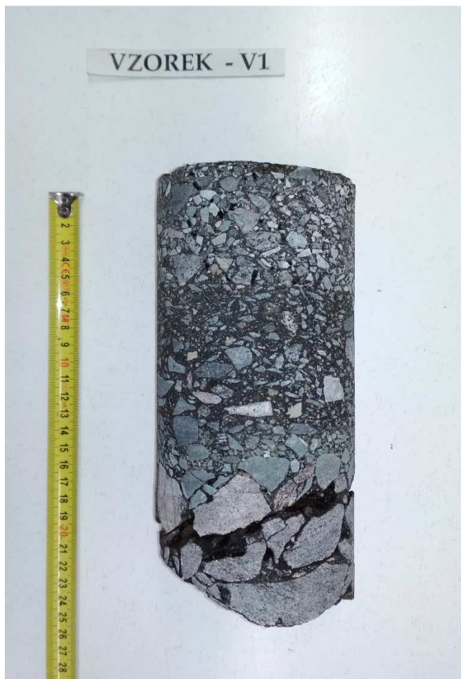
Obr. 2 - Jádru vývrtu Vzorek – V1 (laboratoř).
