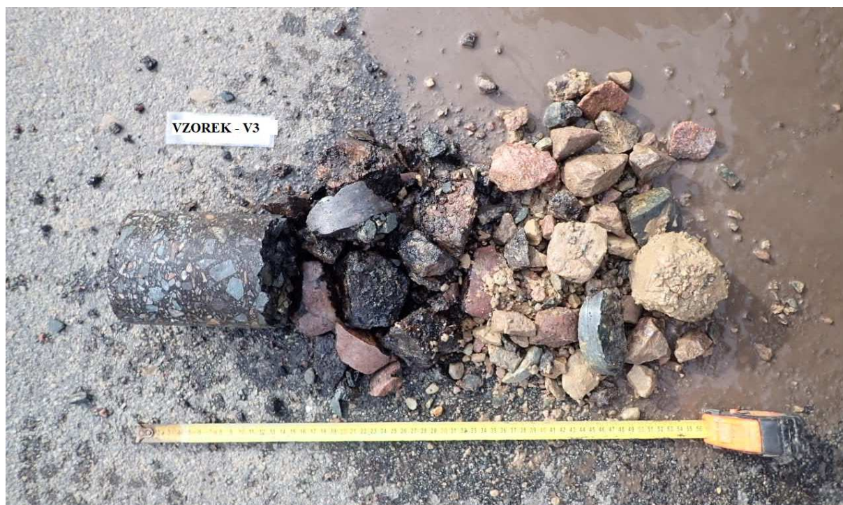
Obr. 5 - Jádro vývrtu Vzorek – V3 (in situ).
