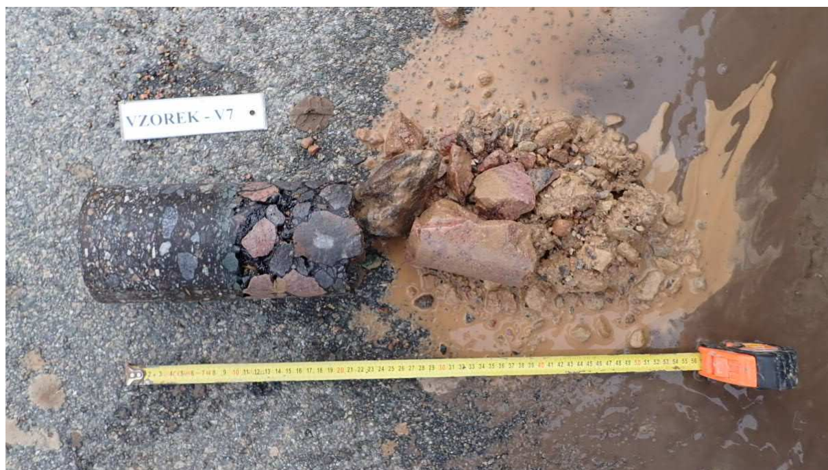
Obr. 13 - Jádro vývrtu Vzorek – V7 (in situ).
